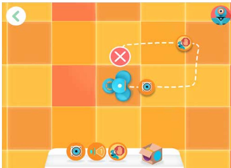
Rysunek 8. Aplikacja Path pozwala zaprogramować robota przez naskikowanie drogi, którą ma pokonać i umieszczenie na niej dodatkowych poleceń (np. zatrzymaj się na jakiś czas, zmień kolor drogi czy wydaj dźwięk).
